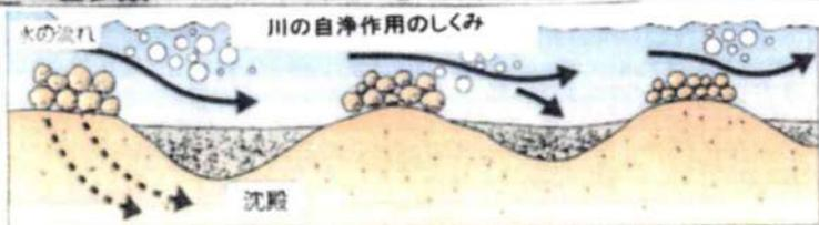
川の自浄作用には、主に「接触沈殿」「吸着」「酸化分解」の3つの段階があります。自然のすぐれた浄化作用を取り入れた浄化施設も建設されるようになりました。
